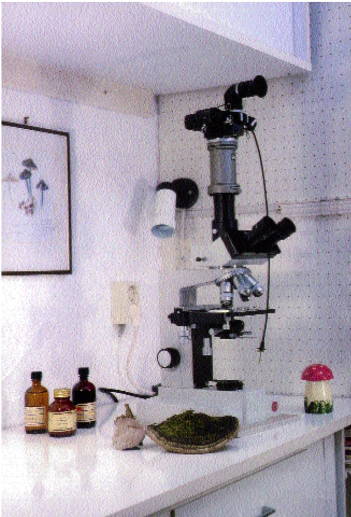
parallel zur Präparatenebene liegt. Die waagerechte Lage der Kamera prüft man, indem man eine kleine Wasserwaage oder -libelle auf die Rückwand der Kamera legt. Besser sind Mikroskop-Stative, bei denen der Tubus starr ist. Es ist dies die Bauform, die man heute ab der Qualitätsstufe Labormikroskop überweigend antrifft.
